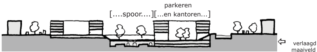
Spoorzone Delft: vergrootte bouwkuip
